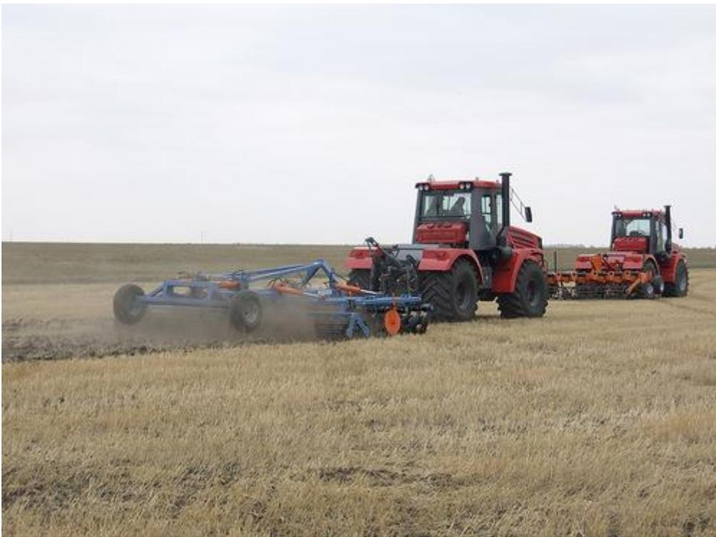
Характеристики дискатора ДА-6х2ПБ (по данным производителя): ширина захвата 6 метров, производительность 7-9 га/ч, рабочая скорость до 15 км/ч, глубина обработки до 6-12 см.
