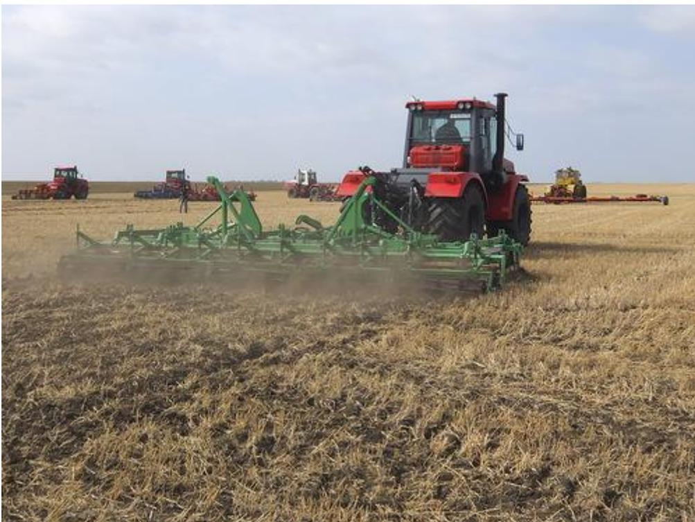
"Кировец" К-744Р2 "Стандарт" с культиватором "Степняк-7,4" Омского экспериментального завода. Характеристики по данным производителя: ширина захвата 7,3 метра, производительность 7,4 га/ч, рабочая скорость 10 км/ч, глубина обработки до 10 см.
