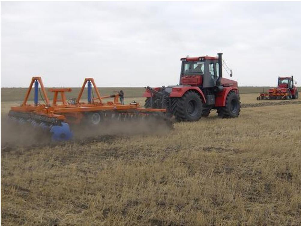
Характеристики бороны БДТ-6ПР (по данным производителя): ширина захвата 6,0 метров, производительность 6,0 га/ч, рабочая скорость до 12 км/ч, глубина обработки до 20 см.
